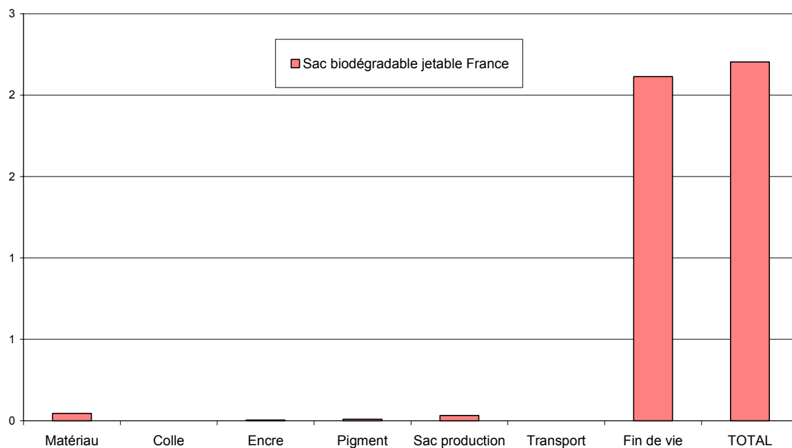
Figure 8: Production de déchets solides par étape du cycle de vie pour le sac biodégradable jetable fabriqué en France
